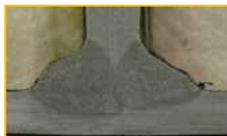
La penetrazione di **Power Focus** su un giunto a T di spessore 10mm, se saldato sui due lati, arriva ad intersecarsi.
