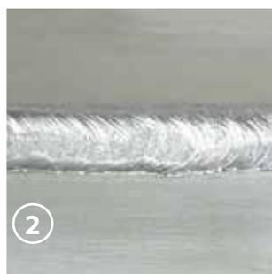
**LIVELLO 2:** si usa la corrente di saldatura ottimizzata per lo spessore e la lavorazione richiesta.
