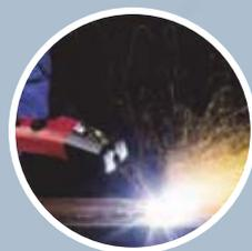
La funzione ARC AIR consente di scriccare perfettamente con elettrodi di carbone fino a 6mm di diametro (Cruiser 402T) e 8mm (Cruiser 502T)
